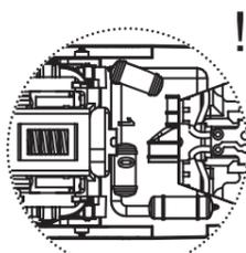
! bei Analogbetrieb kann das Stirnlicht durch verschieben des Schiebeschalter, mit einem feinen Schraubendreher, in Position "0" ausgeschaltet werden!
